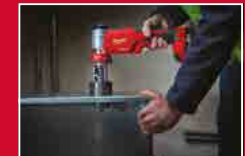
PUNCH - stlačí tlačítko spínača, aby sa diera zlahka vystrihla
