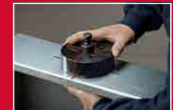
SET UP - výrazné koľčiky a jasný pohľad na pracovnú plochu umožňujú rýchle a jednoduché vyrovnávanie
