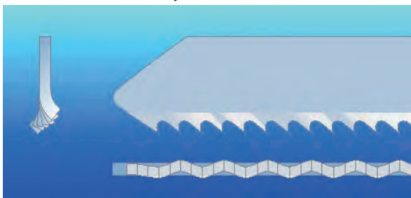
frézované vlnité zuby
